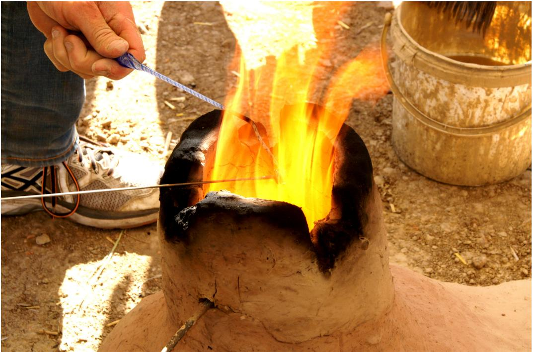
*Abb. 13: Der erste Test des gerade fertiggestellten PO-Borg-5 „Bert“ mit aus nachgemischtem römischem Glas gezogenen und tordierten Glasstäben. – The first test of PO-Borg-5 “Bert” using twisted glass rods made from reconstructed Roman glass (10.6.2017).*
