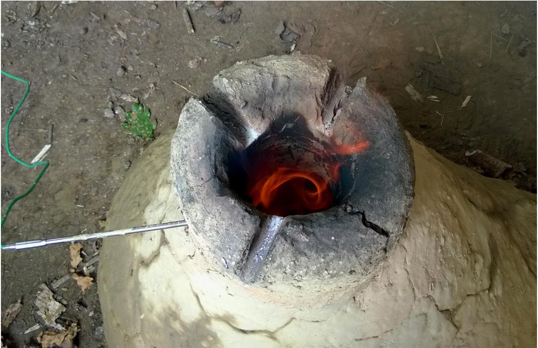
Abb. 10: Der Flammenwirbel beschleunigt das Aufheizen der asymmetrischen Perlenöfen, hier ein Blick in PO-Borg-3 kurz nach dem Anzünden. – The hot cyclone shortens the heating up of the asymmetrical bead furnaces as shown in PO-Borg-3 shortly after starting the fire (30.7.2016).
