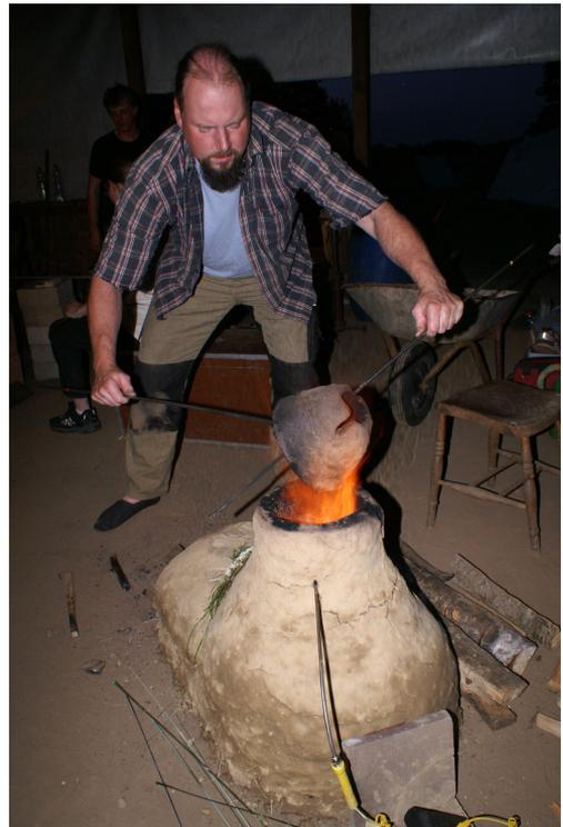
*Abb. 4: Der Reduzierung von PO-Borg-2 hat sich nicht bewährt. – The reduction ring of PO-Borg-2 did not prove to be successful (6.6.2015).*
