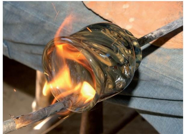
Abb. 10: Aufweiten des geblasenen Mosaikglases (Foto M. Arz).
