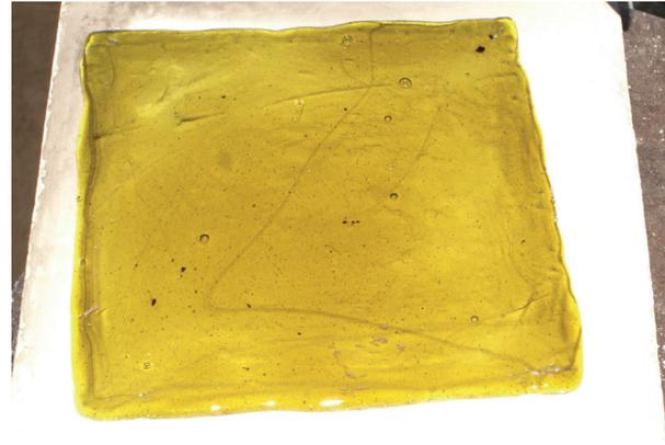
Abb. 12: Streckglas-Fensterglas nach römischem Vorbild (Foto M. Arz).
