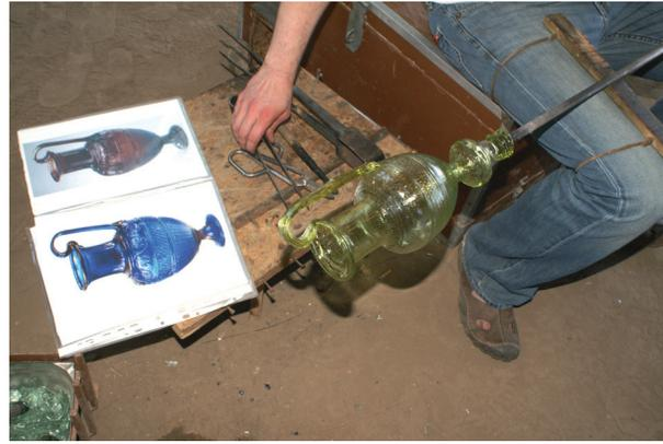
Abb. 5: Der Ennion-Krug, hergestellt aus „frischem“ Glas römischer Rezeptur nach fünf Tagen Läuterungszeit (Foto: M. Arz).
